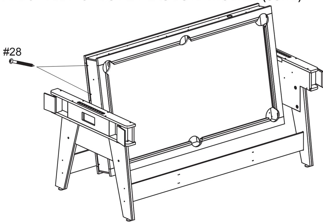
Dans un second temps, faites pivoter la table pour avoir accès aux points de fixation des côtés courts, et fixer 4 vis de chaque côté.
