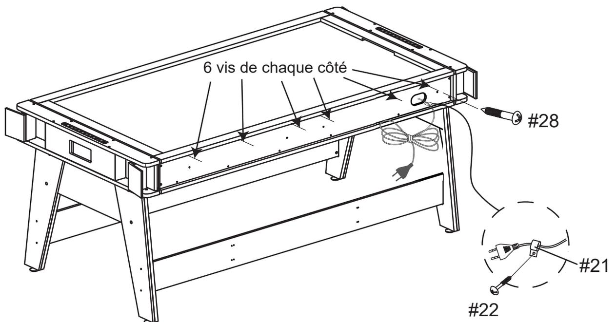
Mettre la table en position horizontale et fixer le plateau du Air hockey, sur la table de billard, à l'aide des vis #28.
