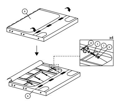
Déserrer le boulon pré-inséré sur le bout de lit avec la clé allen no 12
